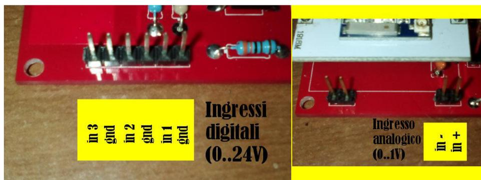
L'ingresso analogico accetta solo tensioni tra 0 ed 1V! Se dovete misurare tensioni superiori usate un partitore resistivo. ATTENZIONE: su questo ingresso non c'è protezione!
